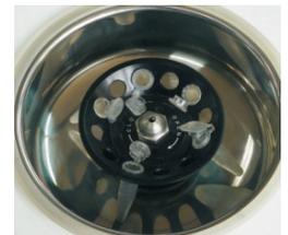
**Foro per vuoto in posizione centrale,** elimina il rischio di contaminazione ed accelera il processo di evaporazione.
